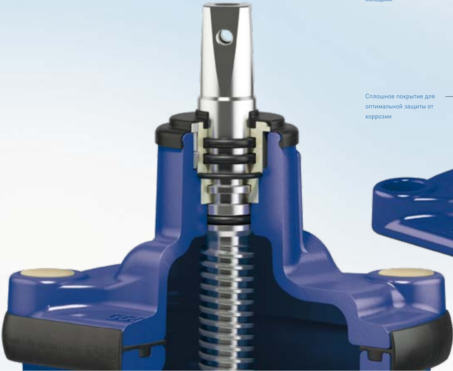
Подшипник шпинделя с байонетным затвором с уплотнительными кольцами
