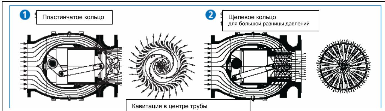
Пластинчатое (лопасти) кольцо – это механизм с равномерно распределенными лопастями, который открывает поток на входе точки уплотнения и прерывает его, обращая во множество отдельных течений, которые придают потоку спиральную форму.
